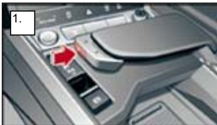
1.ギヤをPポジションに入れる。 (ギヤシフトPボタンを押す)
